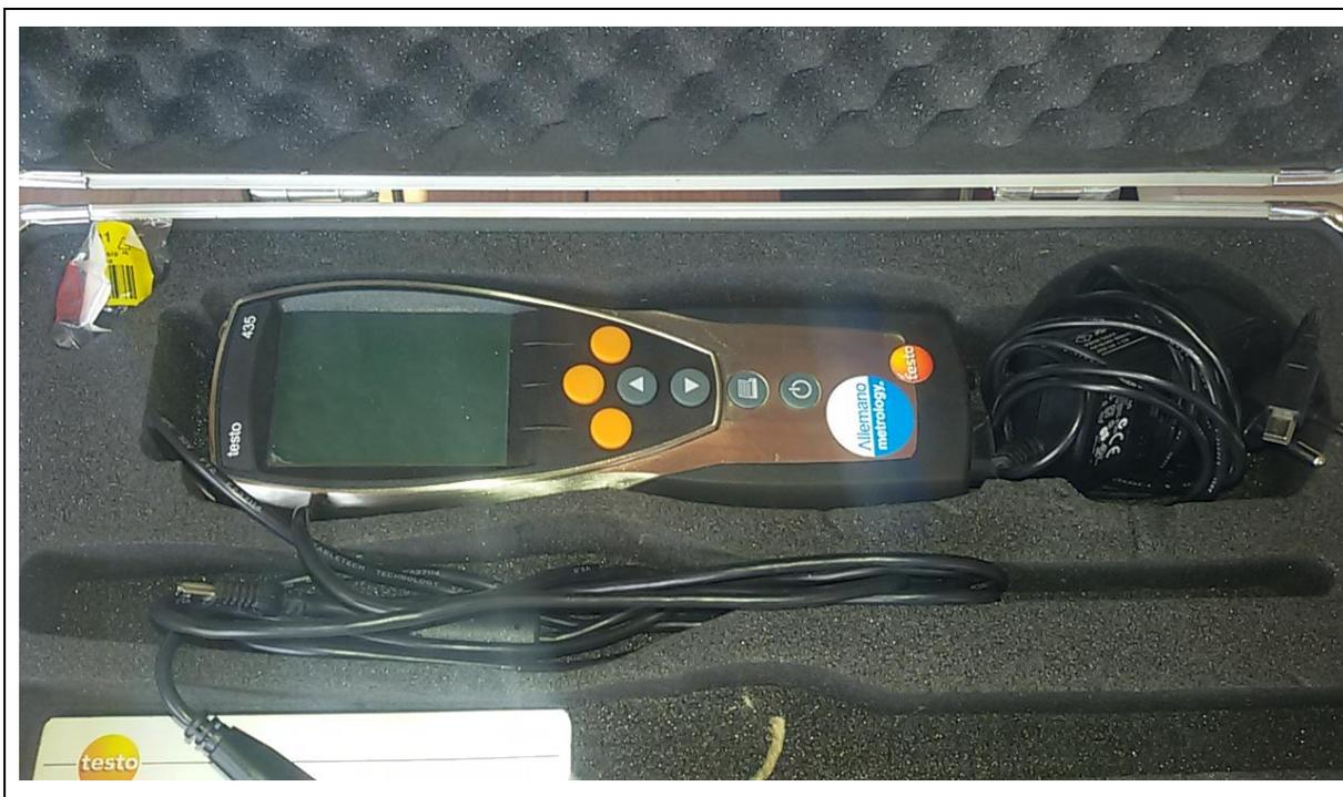
Durante la fase di rilievo, non è stato possibile utilizzare tale strumento in quanto non sussisteva la condizione di differenza di temperatura tra interno ed esterno maggiore di 15°C necessaria alla definizione del valore di trasmittanza termica reale, come disposto dalla norma UNI EN ISO 6946.
